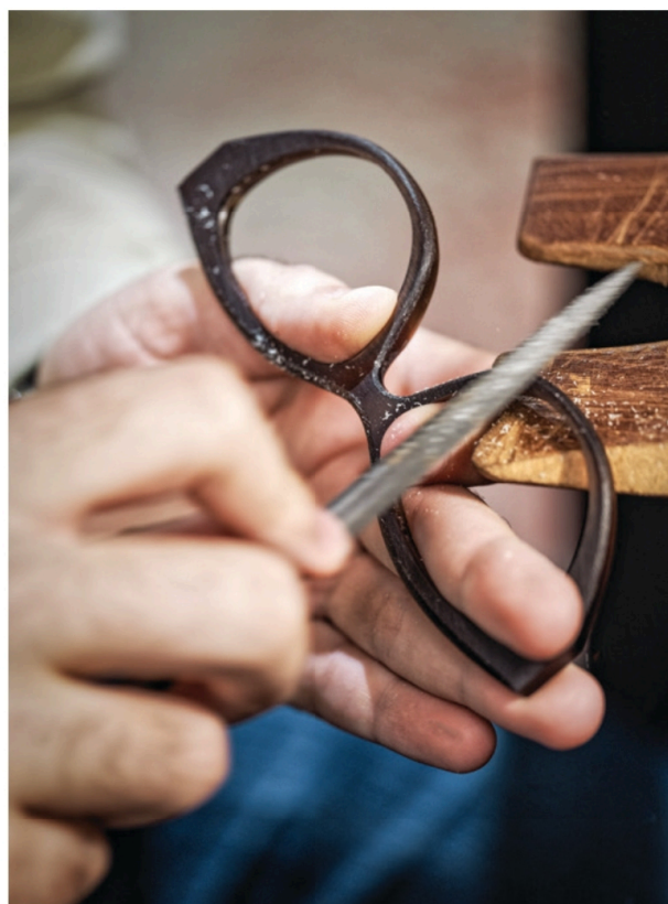
Façonnage d'une monture. Chaque pièce, fabriquée à la main, nécessite une douzaine d'heures de travail.
